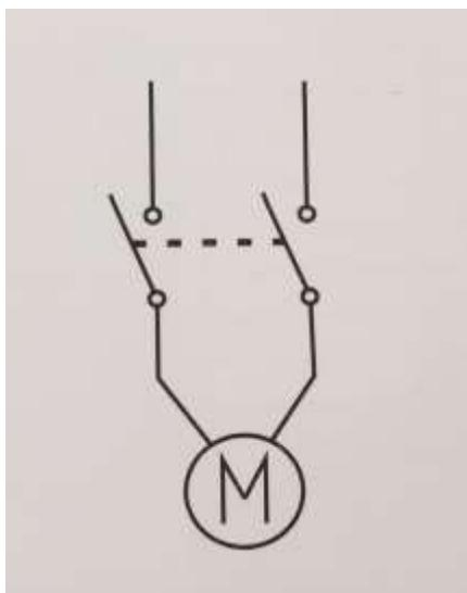
Рис.1- Схема электроподключения
